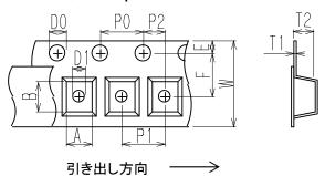
・シールテープ<sup>®</sup>剥離強度 The force to peel away the fixing seal tape 0.1~1.0N
