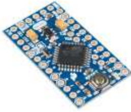
Arduino Pro Mini 328 - 3.3V/8MHz
