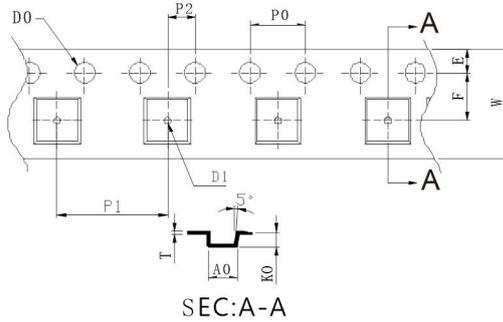
编带方向：缺边对载带圆孔
