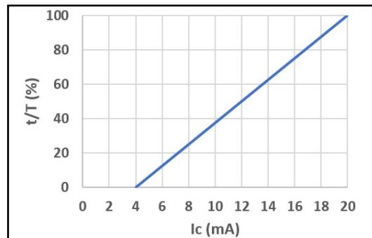
**Caractéristiques de la protection thermique (à 20°C) / Thermal protection characteristics (at 20°C)**
