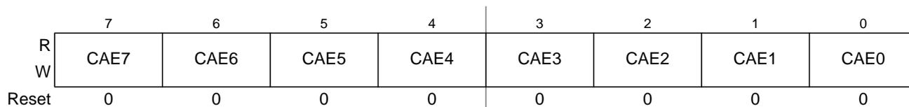
Figure 12-7. PWM Center Align Enable Register (PWMCAE)
