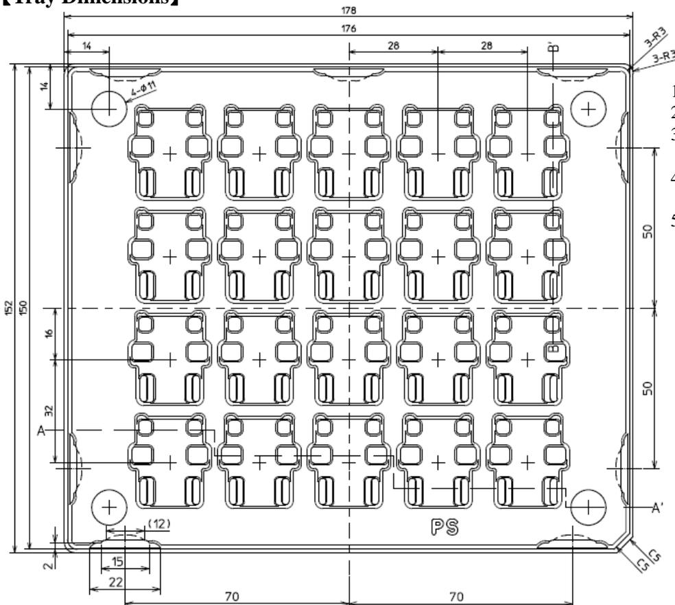
1. Tolerance :  $\pm 0.5\text{mm}$
