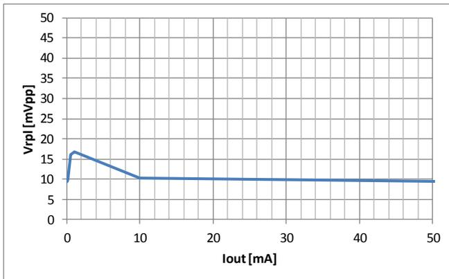
•  $V_{in}=3.7V$ ,  $V_{out}=1.5V$ , BW : 100MHz
