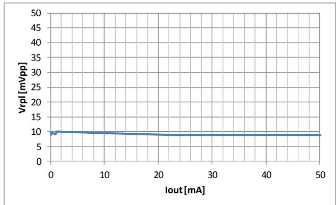
•  $V_{in}=3.7V$ ,  $V_{out}=1.1V$ , BW : 100MHz
