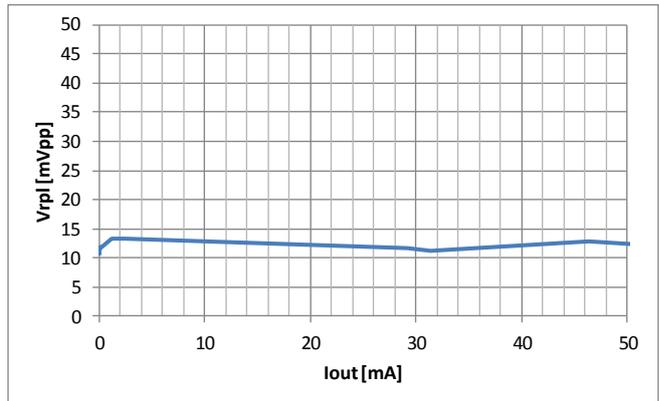
•  $V_{in}=3.7V$ ,  $V_{out}=1.8V$ , BW : 100MHz
