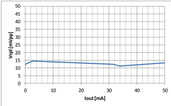
•  $V_{in}=5.0V$ ,  $V_{out}=3.0V$ , BW : 100MHz
