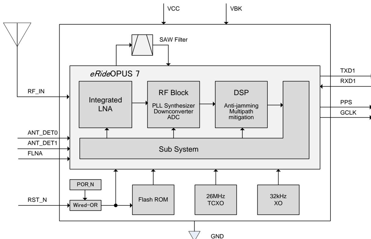
**Figure 2-1. Block Diagram**
